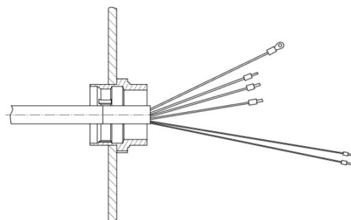
1. Другую часть ЭМС-сальника ввинтить в панель с кабельными вводами на преобразователе частоты. Зубчики прилагаемой контргайки направить к панели с кабельными вводами. Панель с кабельными вводами не снимать.
